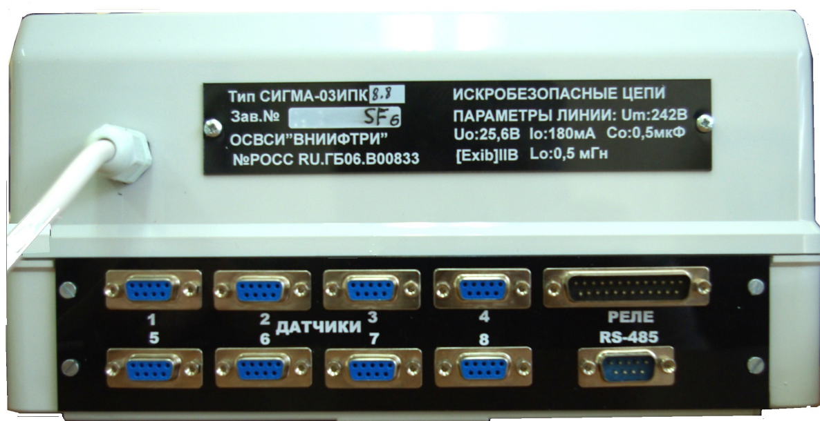
Рис.2. Вид нижней панели блока информационного
