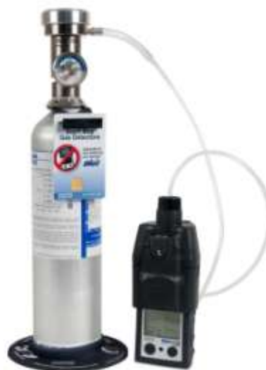
Проверка в режиме принудительного отбора проб с корректировкой по расходу газоанализатора
