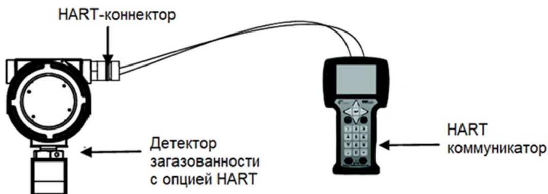
Рисунок 10 – Подключение HART коммуникатора через HART-коннектор
