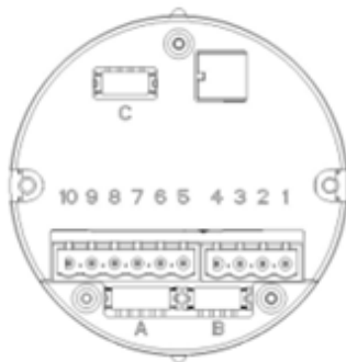
Рисунок 10 - клеммный блок газоанализатора HardGas FX
