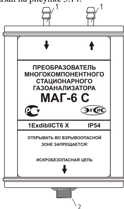
Рисунок 3.14 Измерительный преобразователь прибора МАГ-6 С взрывозащищенного исполнения
