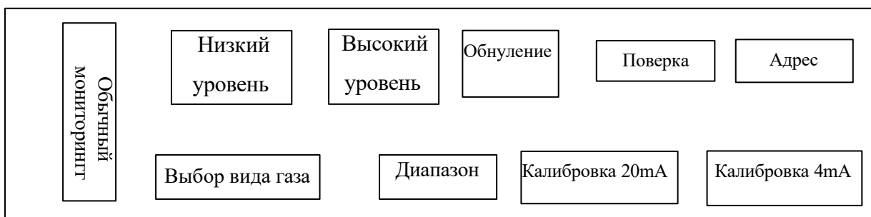
Рис 10 : Схематическое отображение циклической работы
