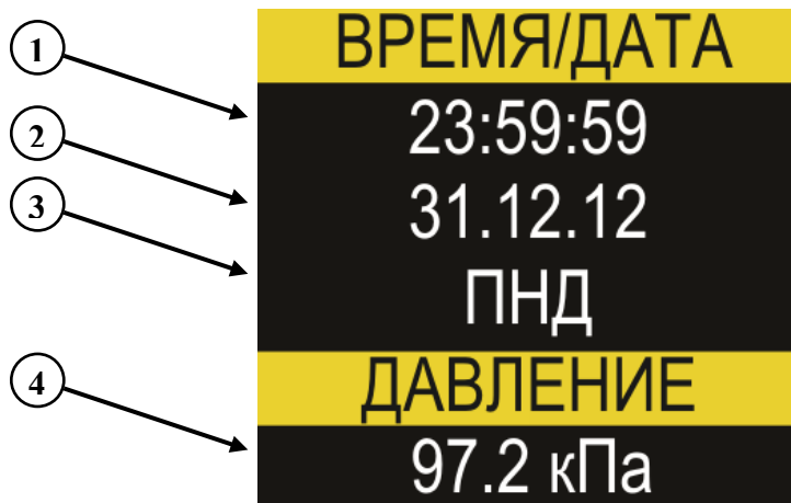
Рисунок 12 – Дисплей в режиме «Дата и время»
