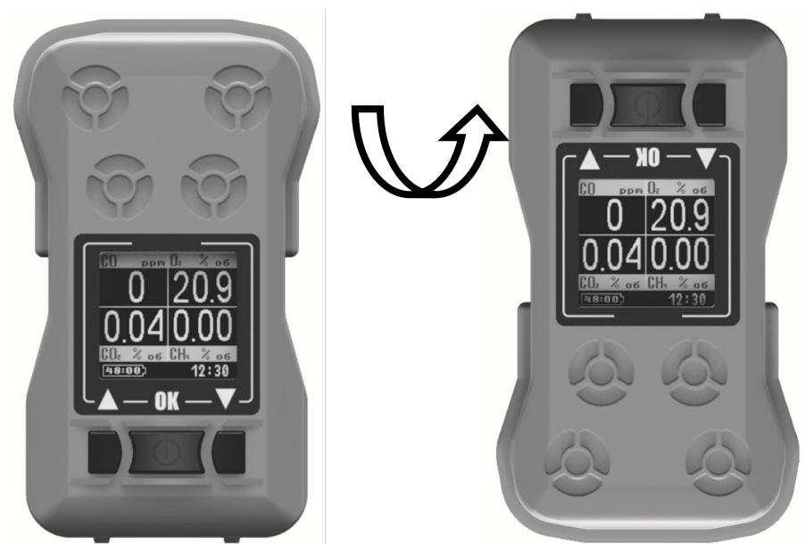
Рисунок 8 - Автоматическая функция поворота изображения на дисплее
