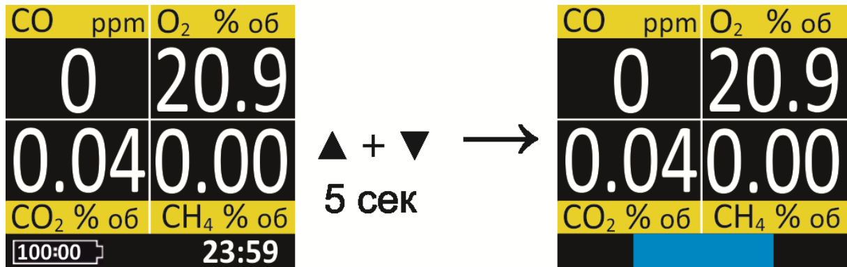
Рисунок 10 – Снятие блокировки дисплея
