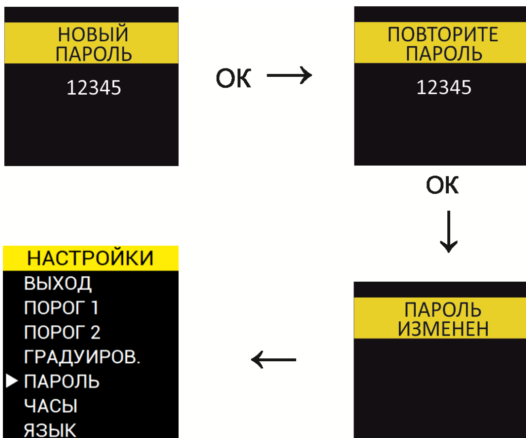
Рисунок 16 – Дисплей в режиме «Пароль»
