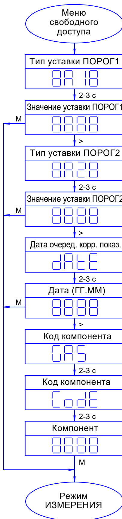
Рисунок А.2 – Меню свободного доступа режима ИЗМЕРЕНИЯ
