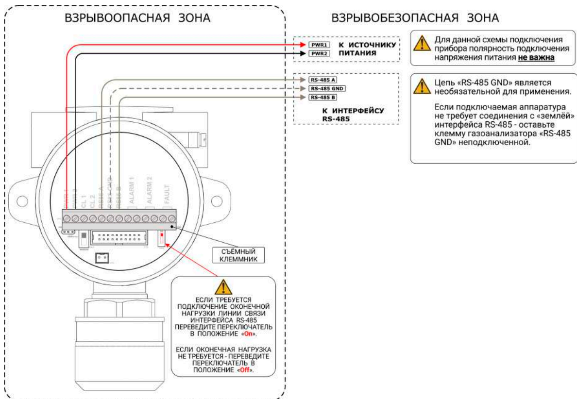
Рисунок 3.13 – Подключение по интерфейсу RS-485
