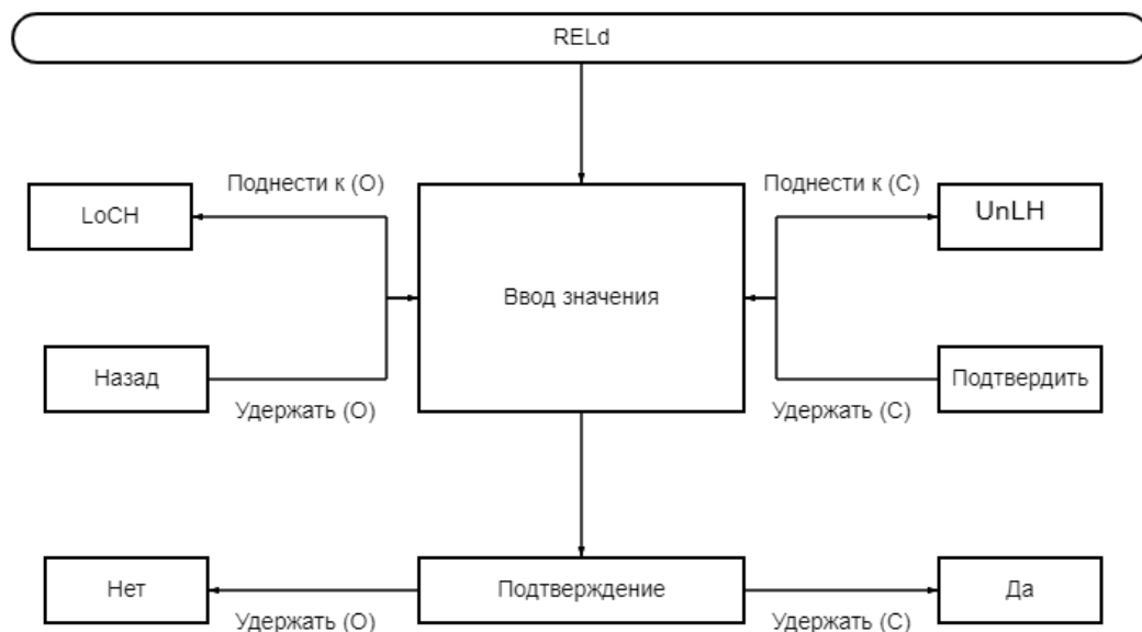
Рисунок К.2.12 – Алгоритм изменения состояния диагностического реле прибора
