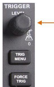
触发电平旋钮
