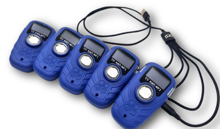
Многоканальный зарядный кабель для КИП-МП (5 выходов) Позволяет одновременно заряжать до пяти приборов КИП-МП — удобно для лабораторий и сервисных служб
